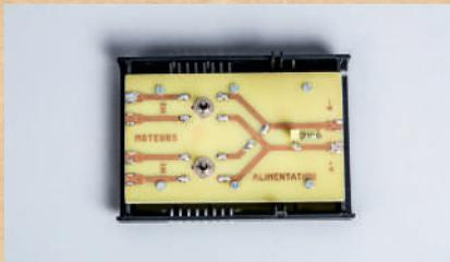
Principalement destiné à la commande manuelle des moteurs, il permet aussi des observations intéressantes avec les cartes d'expérimentation à LEDs, et ainsi poursuivre la construction du concept de sens du courant. Placé entre le bloc d'alimentation et les moteurs, il permet la rotation des moteurs dans les deux sens au moyen des commutateurs.
