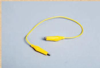
Ils permettent de relier électriquement les différents éléments.
