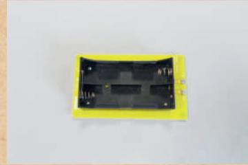
On y insère les 4 piles et on le relie aux moteurs, à la carte d'interface ou aux cartes d'expérimentation.
