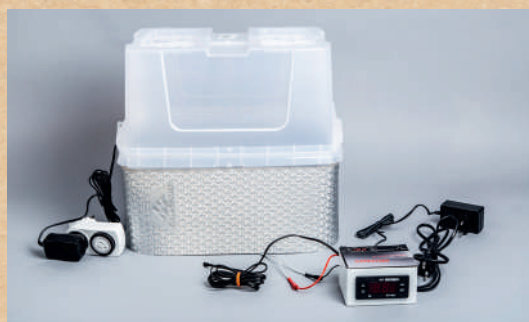
FIGURE 4 - Aperçu du montage complet. Durant l'expérimentation, la sonde doit être placée à l'intérieur du bac, plongée dans le sol.
