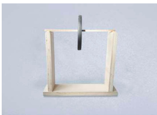
Avec la masse enfilée directement sur l'éprouvette
