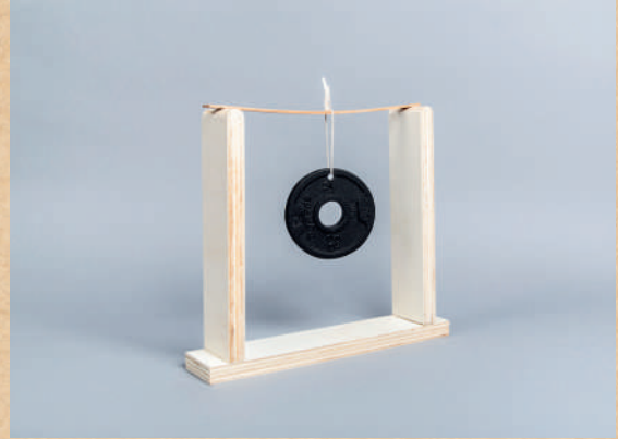
Assemblé avec l'éprouvette de flexion et la masse
