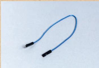
Ces fils de connexion possèdent une extrémité mâle et une extrémité femelle (dans laquelle une extrémité mâle peut être insérée). Ils peuvent ainsi servir à réaliser des rallonges.
