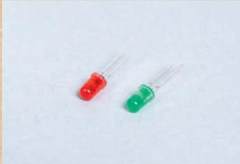
Elles sont composées d'une patte longue (+) à brancher à la tension la plus haute et d'une patte courte (-) à brancher à la tension la plus basse. Il est nécessaire d'ajouter une résistance par DEL dans les montages pour éviter à cette dernière de griller.
