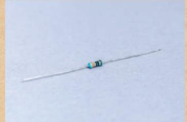
Ajoutée au montage, la résistance permet de limiter la tension aux bornes des DEL et ainsi d'éviter leur dégradation. Il n'y a pas de sens de branchement pour les résistances, mais il faut veiller à bien les monter en série (et pas en parallèle) avec les DEL.
