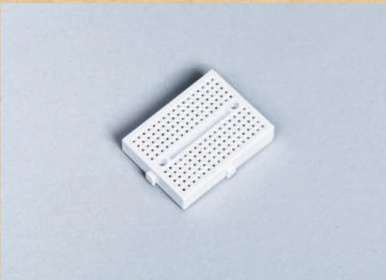
Une breadboard (planche à pain en français) est une platine d'expérimentation permettant de connecter les composants électroniques entre eux en faisant des économies de fils de connexion (jumpers). Comme on peut le voir sur le dessin, une lamelle de métal permet aux 5 trous d'être connectés ensemble :
