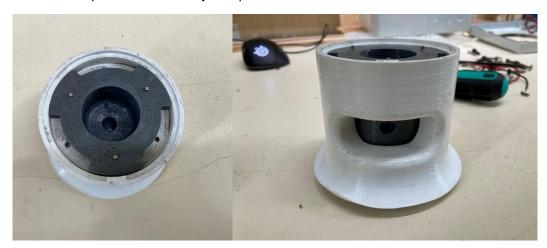
✓ Placez les mâchoires en époxy sur le dessus de l'ensemble. Une lubrification des mâchoires avec une graisse fine est préférable.
