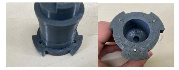
✓ Mise en place de l'entraîneur intérieur dans l'entraîneur extérieur. Il est recommandé de lubrifier les parois internes du joint spi.
