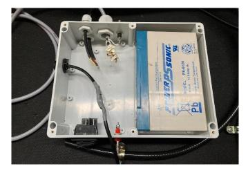
✓ Raccordement des différents composants sur le PCB (bouton de déclenchement, capteur de pression, électrovanne) mise à part l'interrupteur
