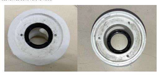
✓ Mise ne place de la couronne dentée rapporter La couronne dentée rapporter est fixée à l'aide de deux vis M4. Un taraudage est préférable.
