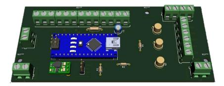
Nous recommandons l'application d'un vernis de tropicalisation afin d'éviter toute oxydation du PCB avec l'humidité.
