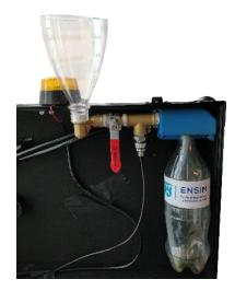
L'autre pièce maîtresse de la mallette est la section de mise sous pression qui permet à la fusée d'avoir de la puissance pour décoller.
