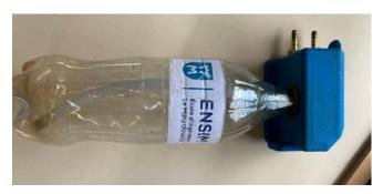
✓ Assemblage des différents éléments de remplissage de contrôle : capteur de pression, groupe de sécurité, valve, etc.
