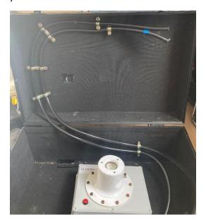
✓ Passage des câbles autour des tuyaux et fixation de la lampe et la sirène
