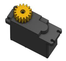
✓ Placez le servomoteur dans l'embase Mettez le servomoteur au milieu de sa course et de même pour l'entraîneur intérieur avant d'enfoncer le servo.
